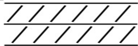
Σχήμα 2-1 Διάταξη νευρώσεων χάλυβα κατηγορίας B500A
