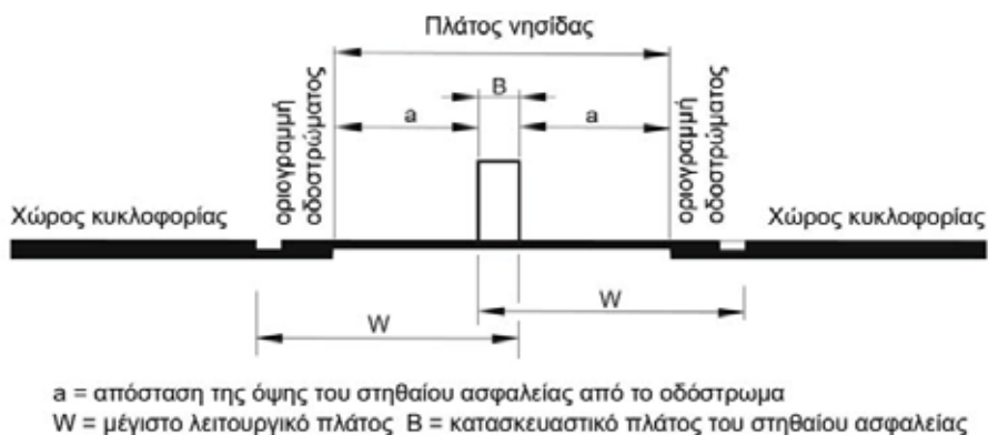
Σχ. 11α: Αμφίπλευρο στηθαίο ασφαλείας που τοποθετείται στο μέσον της νησίδας
