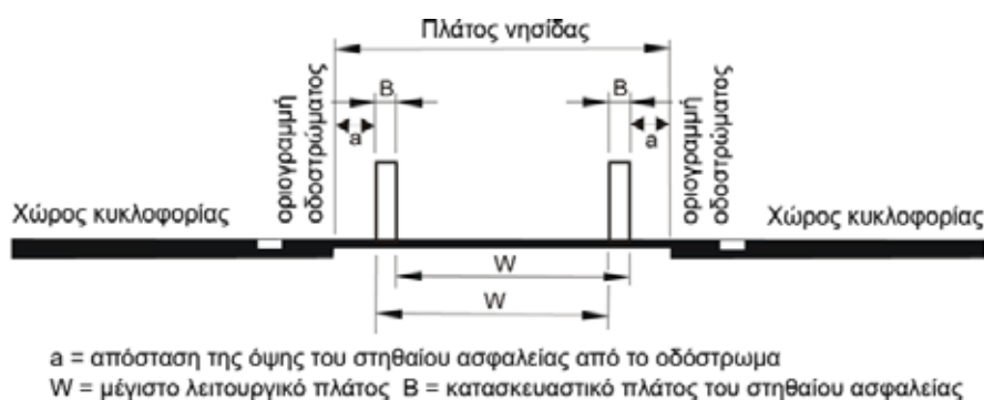
Σχ. 11γ: Μονόπλευρα στηθαία ασφαλείας με χωριστή δράση που τοποθετείται και στις δύο οριογραμμές
