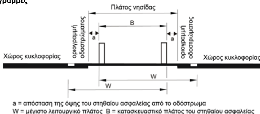
Σχ. 11δ: Μονόπλευρα στηθαία ασφαλείας με κοινή δράση που τοποθετείται και στις δύο οριογραμμές
