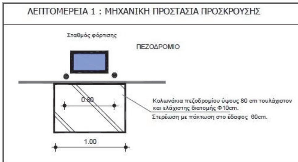
Εικόνα 1.γ: Λεπτομέρεια μηχανικής προστασίας.
