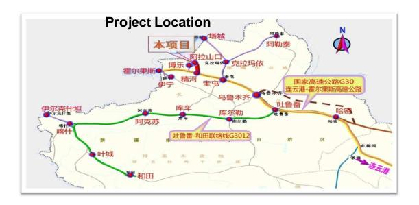
本项目起点位于精河县黑山头东侧,终点位于阿拉山口规划城区南侧,路线全长68.731km。项目采用高速公路双向四车道标准建设,设计速度100km/h。估算总投资34.64亿元
